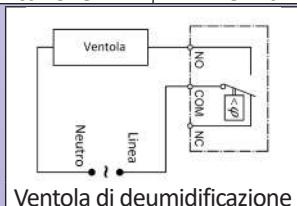
Ventola di deumidificazione
