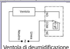
Ventola di deumidificazione
